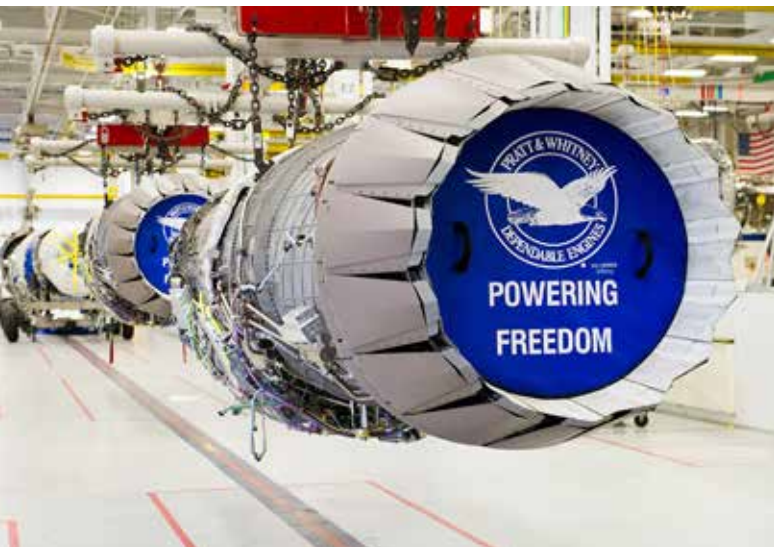
De F135-motor heeft een lengte van ongeveer 3,5 m en heeft een diameter van rond de 1,5 m. (Foto: Pratt & Whitney)
