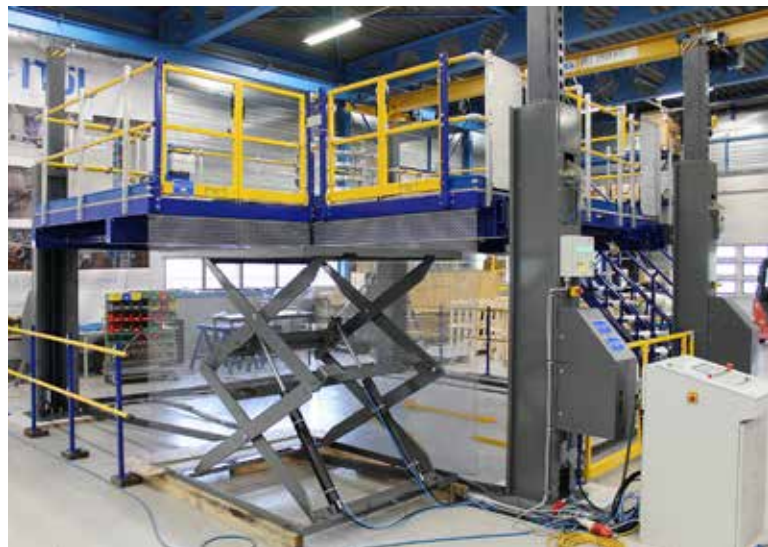
Het onderhoudsplatform beweegt verticaal – uitsluitend zonder mensen – en de motor staat stil. De schaarlift transporteert bijvoorbeeld onderdelen of gereedschap. (Foto: Nijl Aircraft Docking)
